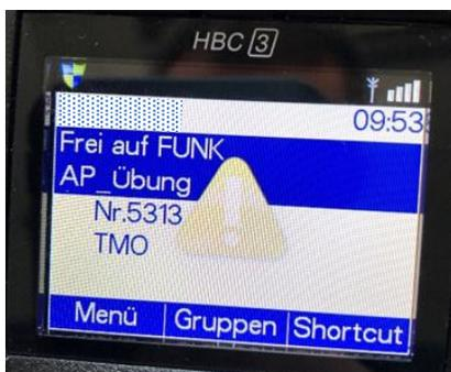
Nach dem Setzen des Status wird dieser vom Einsatzleitsystem quittiert und auch dokumentiert. Eine erfolgreiche Übertragung an das Einsatzleitsystem erkennt man durch den dauerhaften Verbleib im Display des Fahrzeugfunkgerätes.
